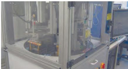
testeur d'endurance avec ses sept stations d'essai autonomes. Les conditions de test qui y sont appliquées constituent pour nous un standard de référence permettant de tirer des conclusions relatives sur la durée de vie des pointes.
