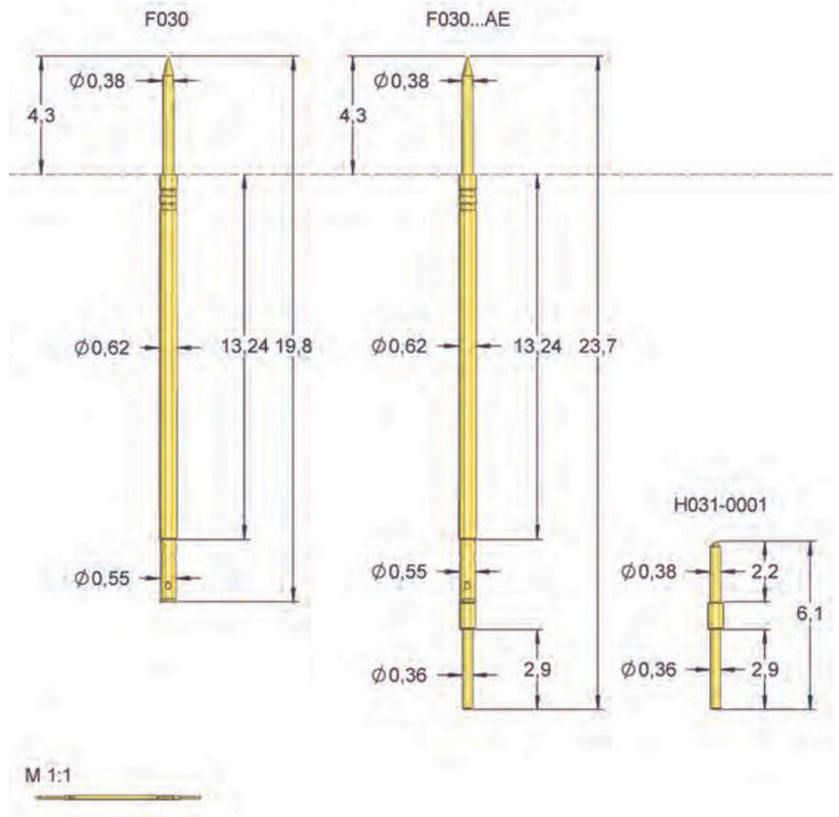
La version AE est la version prémontée composée de la pointe F030 et de l'embout H031-0001.
