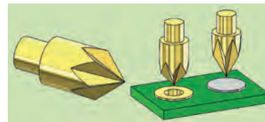
Tête hexagonale (07,08) Pour les trous métallisés, les surfaces de contact et les pads de soudure. Les arêtes vives pénètrent également les couches d'impuretés et les couches d'oxyde.
