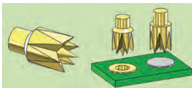
Tête tulipe (36,68) Permet un contact fiable des trous métallisés vides ou entièrement soudés à l'étain.
